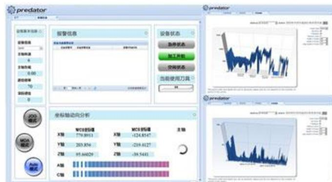
盖勒普 MDC™ 不仅能够支持数控设备的 PLC 数据采集,对于非数控设备也提供了多种采集方案,针对焊机,热处理炉,温控设备等都可以实现组态联网,所采集的数据也都记录到数据库中,方便用户进行查询,并通过报表帮助企业管理人员有效的管理设备。
